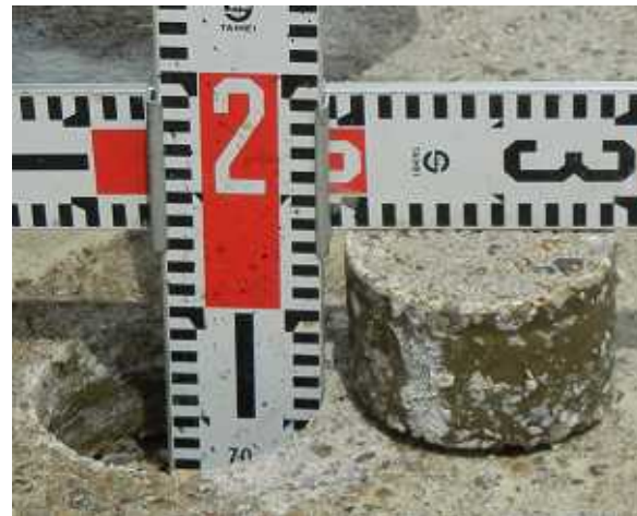
町が一ヶ所だけコア抜き検査を行ったとしている。しかし、丸山議員は、「職員も立ち会っておらず、道路中央部の厚い部分で、とても検査とは言えない」と主張。
